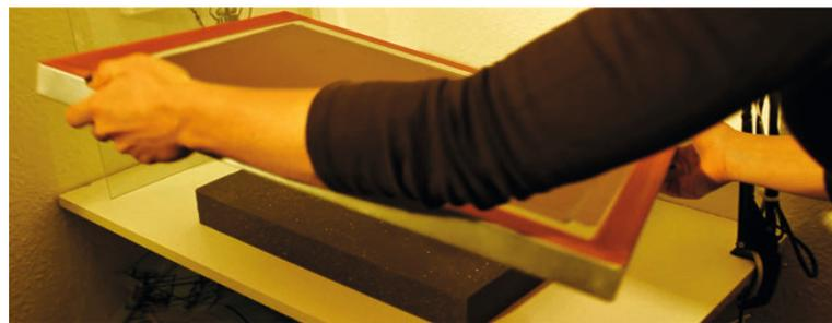
Eine Styroporplatte in der Größe des Siebes sollte innen ins Sieb passen. Die Platte muss so dick sein, dass das Sieb direkt aufliegen kann. Die Folie muss spiegelverkehrt auf das Sieb gelegt werden (Druck zum Sieb!).
